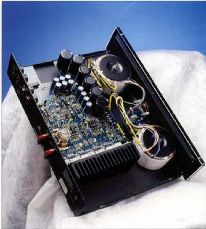
Ein schöner Anblick: Innenleben der Endstufe AW 220 MB mit einem satten Ringkerntrafo pro Kanal (oben). In der Vorstufe (rechts) führt das Gestänge vom Motorpoti nicht zu einem Drehknopf, sondern zur Lautstärkeanzeige.
